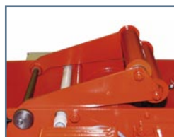
Schlaffseilswitch (3) Slack-rope switch (3) Détection de brin mou (3)
