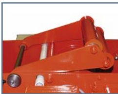
Schlaffseilschalter (3) Slack-rope switch (3) Détection de brin mou (3)
