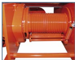
Seilandruckrolle Pressure roller Rouleau presse cable
